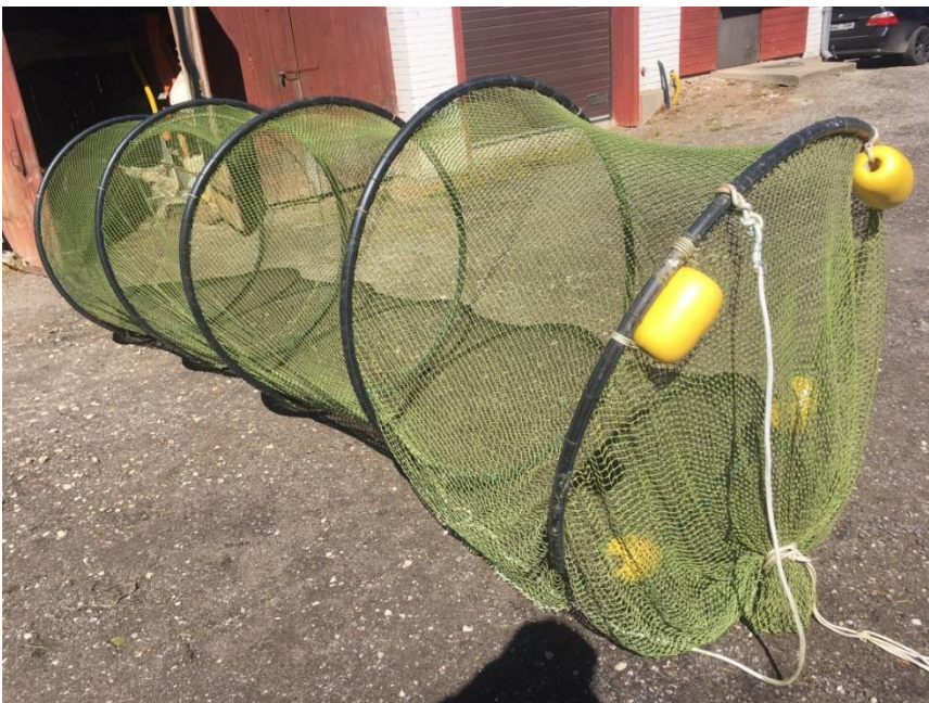
Joonis 2. Kala ellujäämise mõõtmiseks kasutatav sump. Alumine osa ankurdatakse järvepõhja ja ülemine osa ujub veepinnal.
