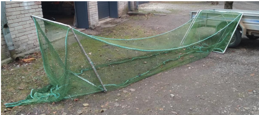
Joonis 2. Horisontaalselt paigutatav sump.
