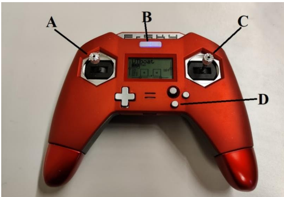
Joonis 6. Laeva juhtpult, millel on tähistatud olulisemad juhtnupud (A- pötkurid, B- puldi käivitamine, C-kiirus ja suund, D- funktsioon muudetav) .
