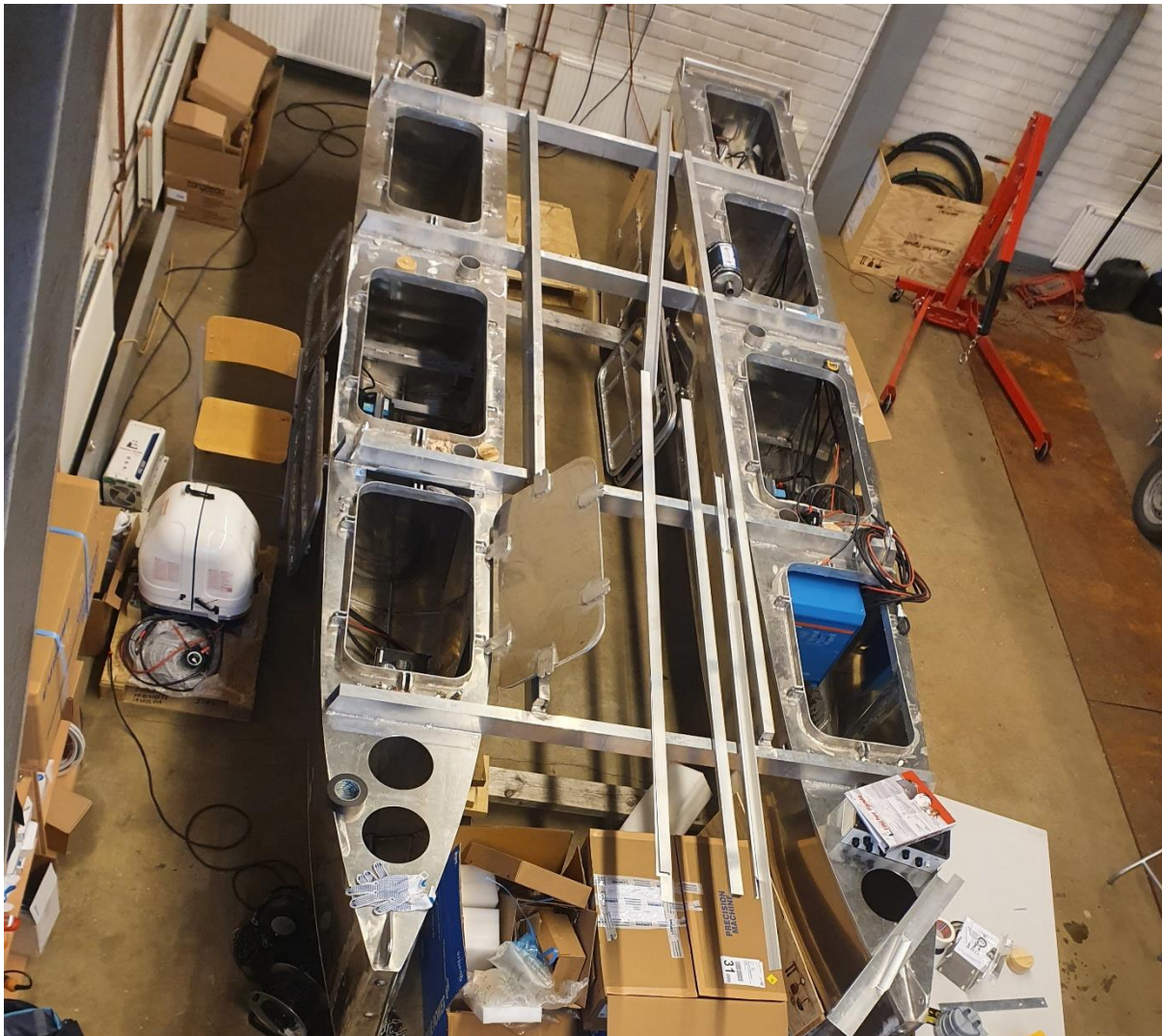
Joonis 2. Autonoomse veesõiduki korpuse konstrueerimine.
